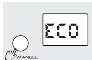
*En cas d'absence de courte durée (moins de 24h), il est conseillé, pour un maximum d'économie, d'utiliser ce mode de fonctionnement. Il provoque un abaissement de la température de la pièce de 3,5.°C environ par rapport à la température **CONFORT**.*
