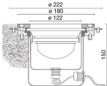
Esempio di installazione in vasche con guaina in PVC
