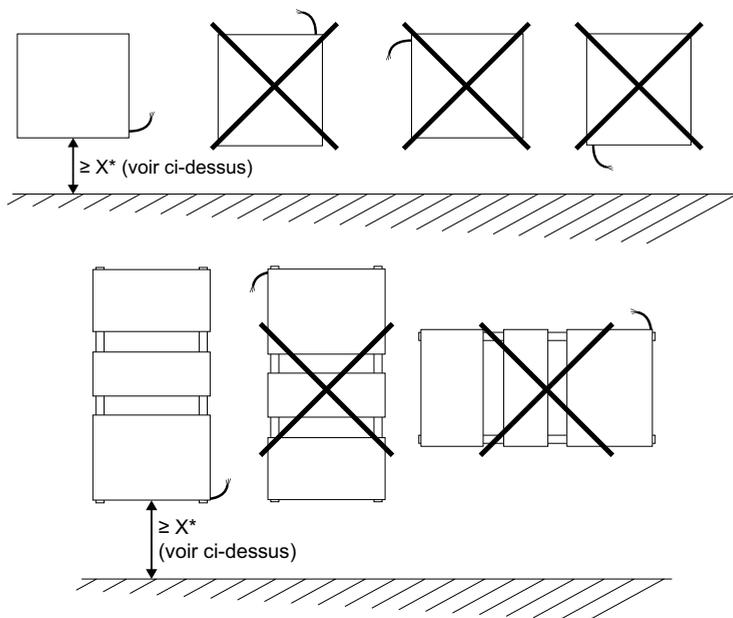
**REMARQUE :** les radiateurs sèche-serviettes électriques sont conçus pour être recouverts sans danger. Pour garantir un fonctionnement efficace de votre appareil, il est toutefois recommandé de ne pas le couvrir entièrement. Du fait de l'élévation de température et grâce au coupe-circuit interne, il peut dans ce cas interrompre son fonctionnement.
