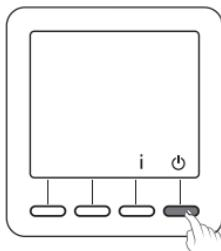
Dans ce mode, le chauffage est en arrêt.
