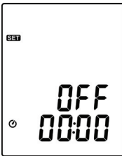
(7) Fig.7 Réglage de l'arrêt automatique.
