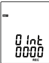
(3) Fig.3 Réglage de la fréquence d'échantillonnage pour l'enregistrement.
