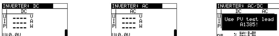
Schéma 6.4 : Exemples d'écrans de démarrage de test sur un onduleur PV – monophasé a.c
