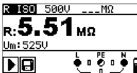
Schéma 5.7 : Exemple de résultat de mesure de résistance d'isolement
