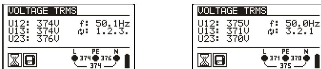
Schéma 5.4 : Exemple de mesure de tension sur un système triphasé
