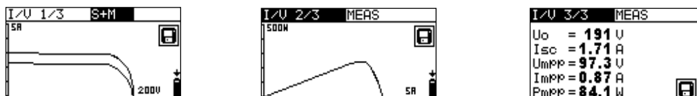
Schéma 6.26 : Exemple de résultats de courbe I / V
