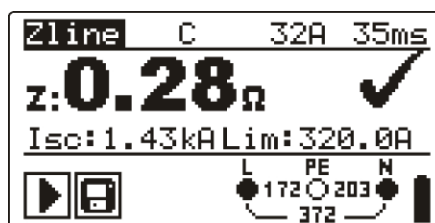
Schéma 5.29 : Exemple de résultat de mesure d'impédance de ligne
