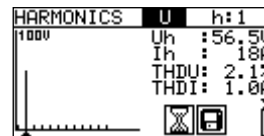
Schéma 7.5 : Exemples de résultats de mesure harmoniques
