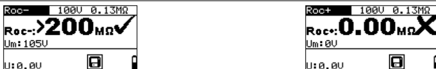
Schéma 6.3 : Exemple de résultat de mesure de résistance d'isolement
