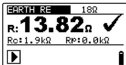
Schéma 5.35 : Exemple de résultat de mesure de résistance de terre
