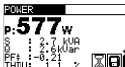
Schéma 7.3 : Résultats de mesure de puissance
