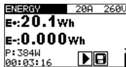
Schéma 7.12 : Exemples de résultats de mesures d'énergie
