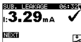
Illustration 6.9: Configurateur VDE - écran de résultat de la mesure du courant de fuite par méthode de substitution.
