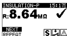
Illustration 6.13: Configurateur VDE - écran de résultat de la mesure de la résistance d'isolement- P
