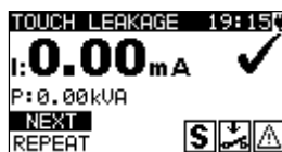
Illustration 6.18: Configurateur VDE - écran de résultat de la mesure du courant de fuite de contact
