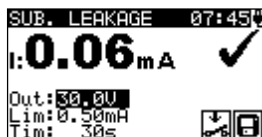
Illustration 5.19: Exemples de résultat de mesure de courant de fuite par méthode de substitution
