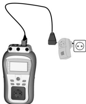
B) Test de DDR portable via une prise secteur
