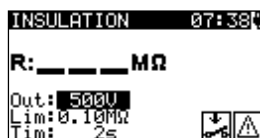
Illustration 6.29: Écran de démarrage de la mesure de résistance d'isolement
