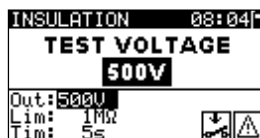
Illustration 6.5: Configurateur VDE - écran de démarrage de la mesure de la résistance d'isolement
