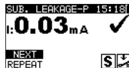
Illustration 6.16: Configurateur VDE - écran de résultat de la mesure du courant de fuite de substitution -P
