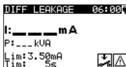
Illustration 6.33: Écran de démarrage de mesure du courant de fuite différentiel.
