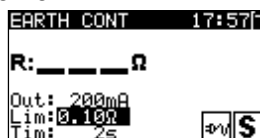
Illustration 6.27: Écran de démarrage de la mesure de résistance du conducteur de terre
