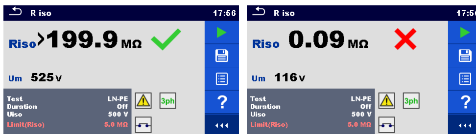
Image 6.76: Exemples de résultats de mesure de la résistance de l'isolement (équipement de soudure)
