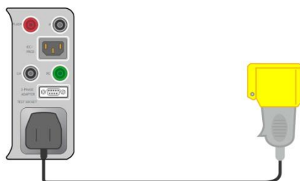
Image 9.2: Connecter l'adaptateur de Test 110V (A 1474)
