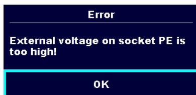
Lors du pré-test, une tension externe trop élevée a été détectée entre les bornes LN et PE. La mesure a été annulée. Appuyer sur OK pour continuer.
