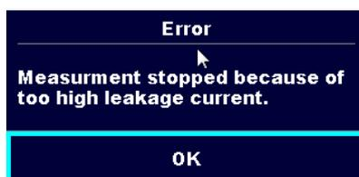
Le courant de fuite mesuré (Idiff, Ipe, Itouch, ...) était supérieur à 20 mA. La mesure a été interrompue. Appuyer sur **OK** pour continuer.
