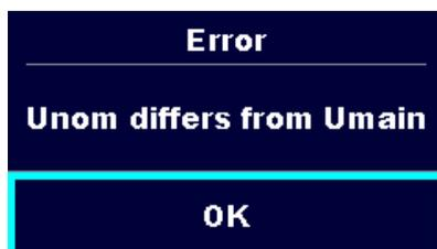
L'Unom réglé diffère trop de la tension secteur mesurée. Le paramètre ou la tension secteur doit être modifié(e).
