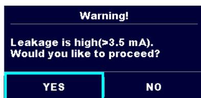
Lors du pré-test, un courant de fuite élevé a été détecté. Il est probable qu'un courant de fuite dangereux (supérieur à 3,5 mA) circule après la mise sous tension de l'appareil testé.
