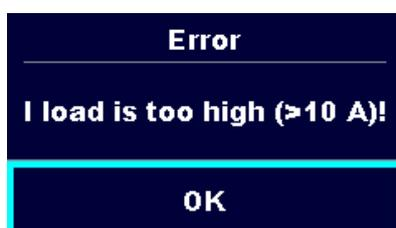
Un courant de charge moyen supérieur à 10 A sur les 5 dernières minutes de l'intervalle de test est détecté. La mesure est arrêtée. Une période de récupération pour le refroidissement est nécessaire avant de poursuivre les tests ! Appuyez sur **OK** pour continuer.
