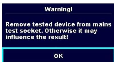
Dans la deuxième étape du test Itou+Ifi, l'objet sous test doit être déconnecté de la prise de test du réseau. Déconnectez l'objet sous test de la prise de courant et appuyez sur OK pour continuer.
