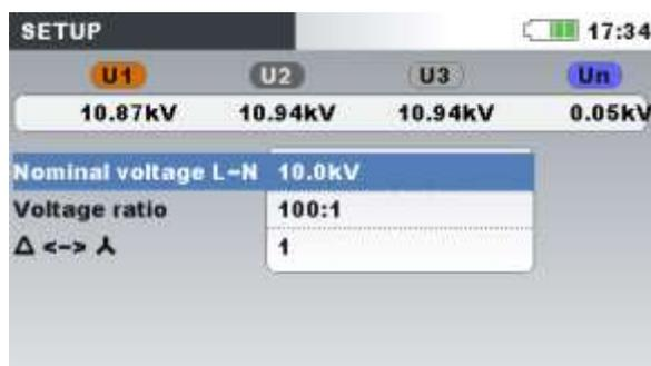
**Ratio de tension:** Ratio du transformateur  $\Delta \leftrightarrow \lambda$ :
