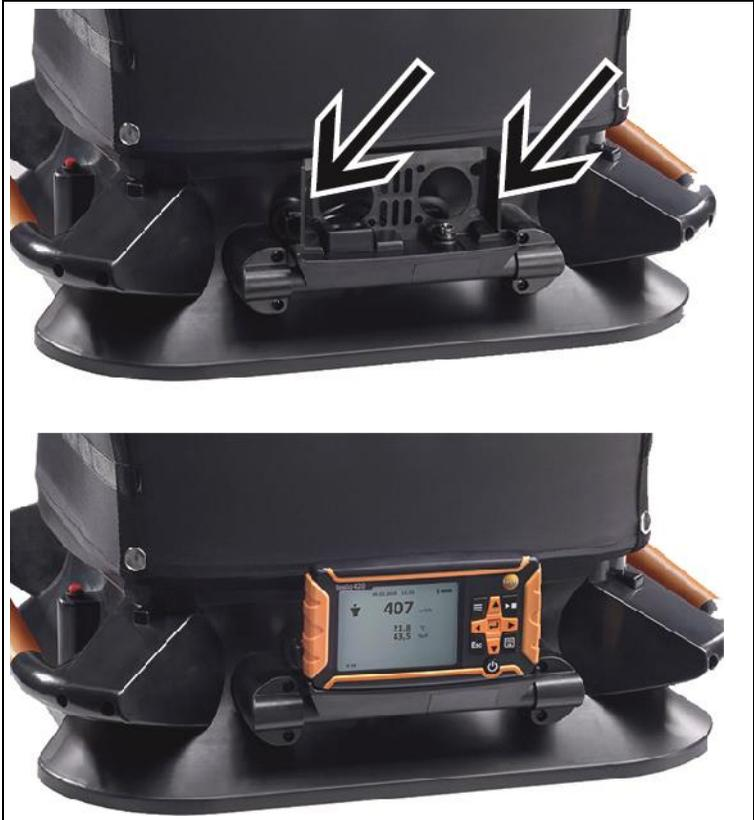
1. Introduisez totalement le testo 420 dans le logement de l'appareil ; tenez compte ici des arrêts à gauche et à droite dans le support.
