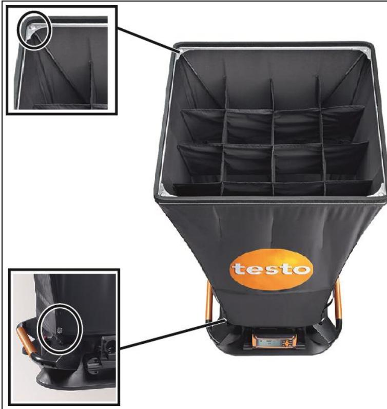
1. Placez l'extrémité inférieure de la hotte sur le socle de mesure.
