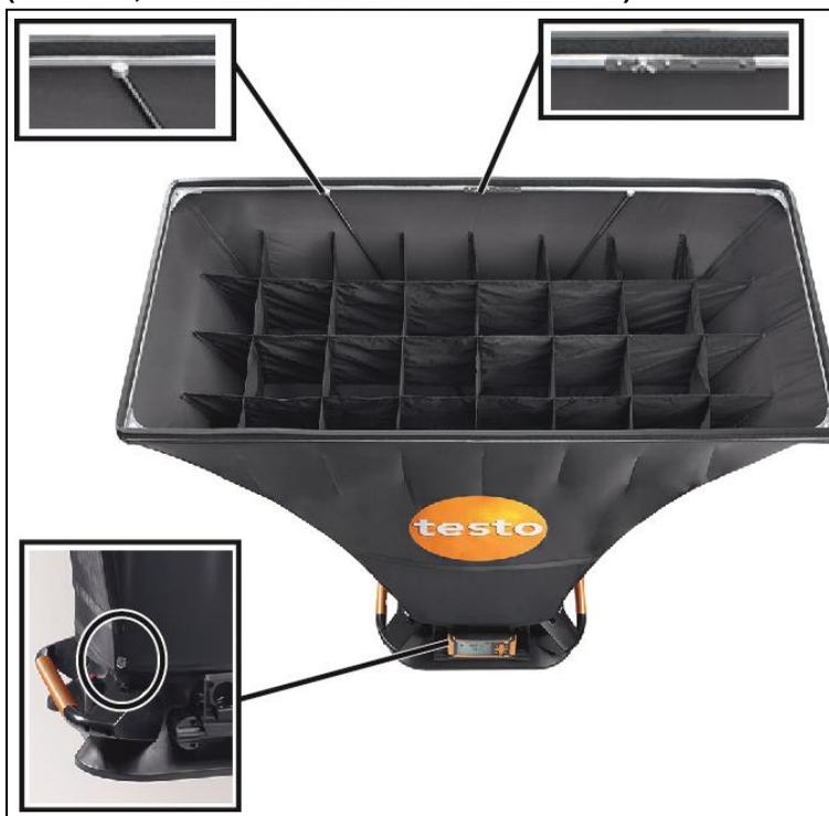
1. Montez le cadre en alu et tendez la hotte en tissu sur le cadre de sorte que la bande en caoutchouc passe dans le creux du cadre. Veillez ici à ce que la bande en caoutchouc soit correctement placée, surtout dans les angles.
