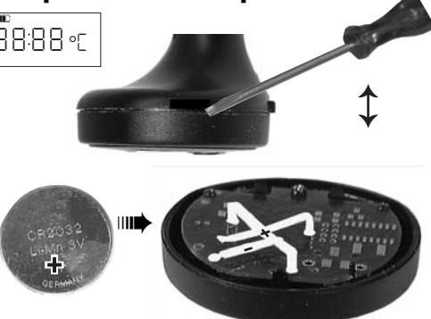
Si le signal apparaît pendant la mesure, ouvrez l'appareil à l'aide d'un tournevis.
