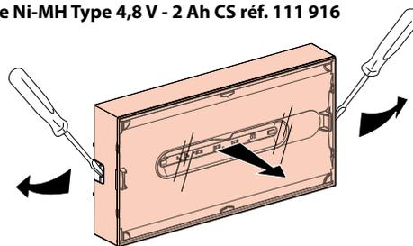
Les accumulateurs doivent être remplacés lorsque le bloc autonome ne satisfait plus à sa durée assignée de fonctionnement.
