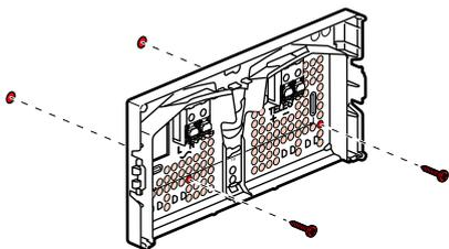
Fixation possible sur boîte d'encastrement Ø 60 :
