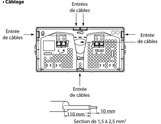
TELEC - Bornes de raccordement : pas de sens de raccordement avec la télécommande Ura réf. 140 011 /140 012.
