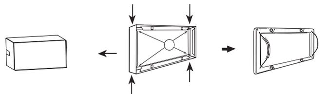
• **Fixation du diffuseur sur le socle en acier.**
