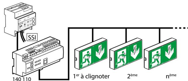
Ce paramétrage doit être fait avec la passerelle de configuration réf. 140 132 et l'application CloseUp. Cette action permet d'attribuer un numéro qui indique la position du bloc dans la file.
