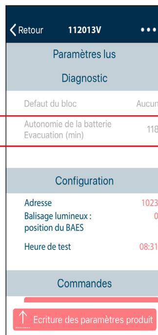
Ces paramètres permettent de visualiser la durée de l'autonomie des batteries (mesurée en minute) lors du dernier test trimestriel.
