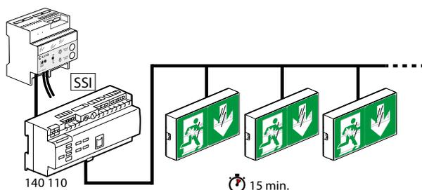
**Nota:** Il est possible d'arrêter le mode visibilité augmentée quand la boucle SSI est refermée par deux appuis successifs sur la touche "Extinction"
