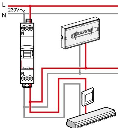
La dérivation peut se faire dans l'armoire électrique, sur l'interrupteur ou dans une boîte de dérivation. L'alimentation des blocs est soumise aux mêmes règles que les luminaires (câblage normal).
