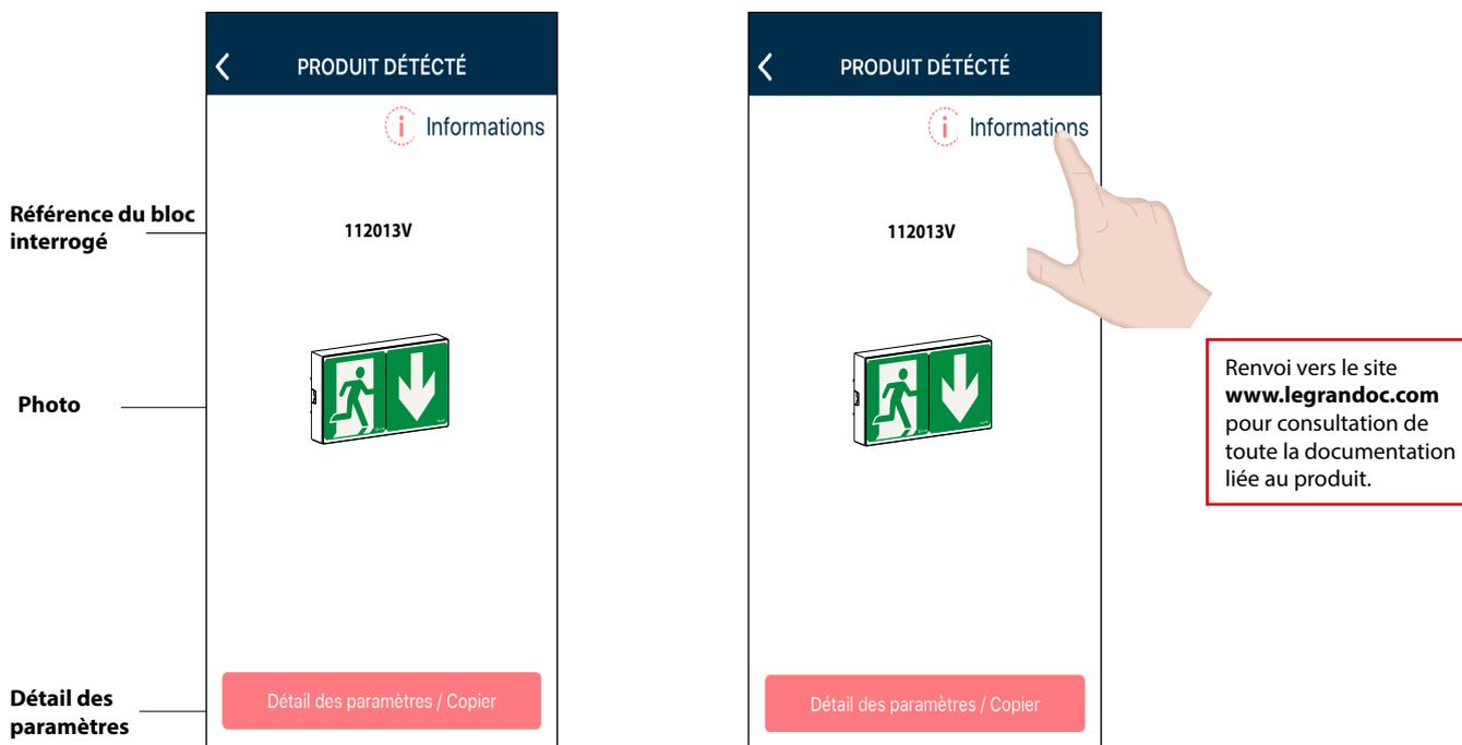
Etape 2 : Cliquer sur "DÉTAIL DES PARAMÈTRES" pour avoir accès à la liste complète des paramètres et à des informations complémentaires. Durant cette étape il faut maintenir la passerelle en direction du bloc interrogé, le chargement des paramètres est visualisable sur l'écran du téléphone.
