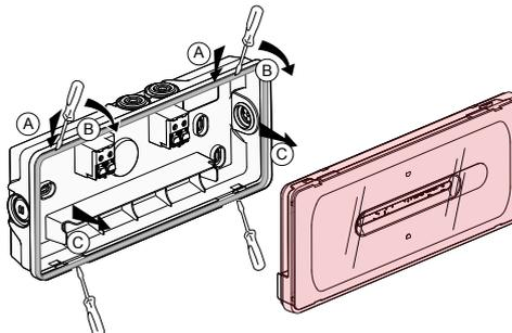
Les accumulateurs doivent être remplacés lorsque le bloc autonome ne satisfait plus à sa durée assignée de fonctionnement.
