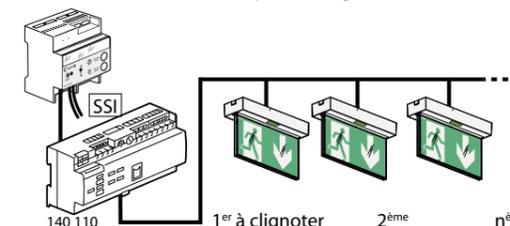
Ce paramétrage doit être fait avec la passerelle de configuration réf. 140 132 et l'application CloseUp. Cette action permet d'attribuer un numéro d'ordre qui indique la position du bloc dans la file.
