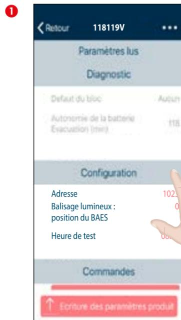
Dans la partie "Configuration" cliquer à droite de "Balisage lumineux : position du BAES" sur le numéro
