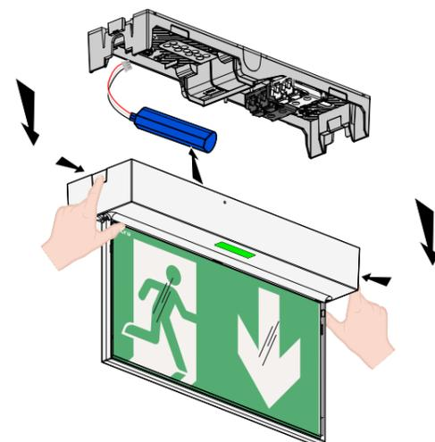
Les accumulateurs doivent être remplacés lorsque le bloc autonome ne satisfait plus à sa durée assignée de fonctionnement.
