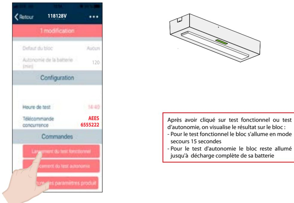
Après avoir cliqué sur test fonctionnel ou test d'autonomie, on visualise le résultat sur le bloc :
