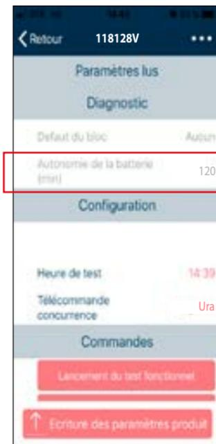
Ce paramètre permet de visualiser la durée de l'autonomie de la batterie (mesurée en minute) lors du dernier test trimestriel.
