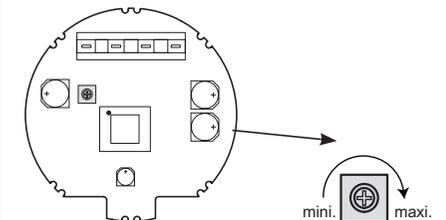
Potentiomètre réglé d'origine sur la position
