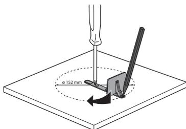
Découper, selon le support, à l'aide d'une scie sabre ou d'un cutter de sécurité à lame rétractable, un trou de Ø 152 mm.
