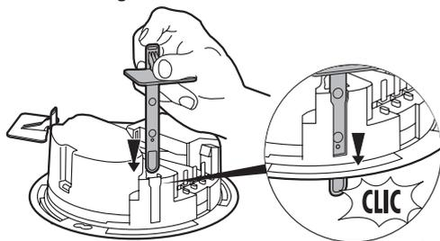
⚠ Pré-positionner les languettes de fixation jusqu'au 1<sup>er</sup> CLIC. Elles doivent dépasser à l'arrière du bloc pour faciliter la mise en place.
