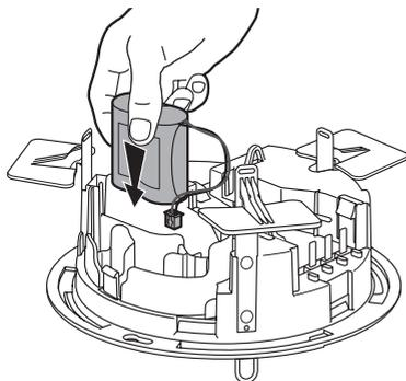
**4** Remplacer par les nouvelles batteries.
