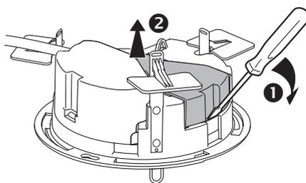
Libérer le clip de verrouillage de chaque languette à l'aide d'un tournevis et repousser les languettes vers le haut pour déblocage du bloc.
