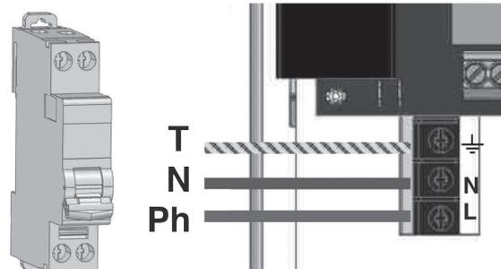
L'alimentation électrique 230 Vac doit être protégée avec un disjoncteur courbe C adapté.
