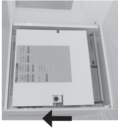
Déplacer le capot pour désolidariser le capot du socle.
