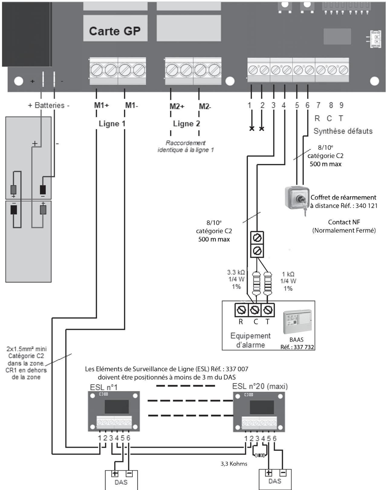
La résistance de 3,3 Kohms doit être raccordée en parallèle, sur la ligne, dans le dernier DAS.
