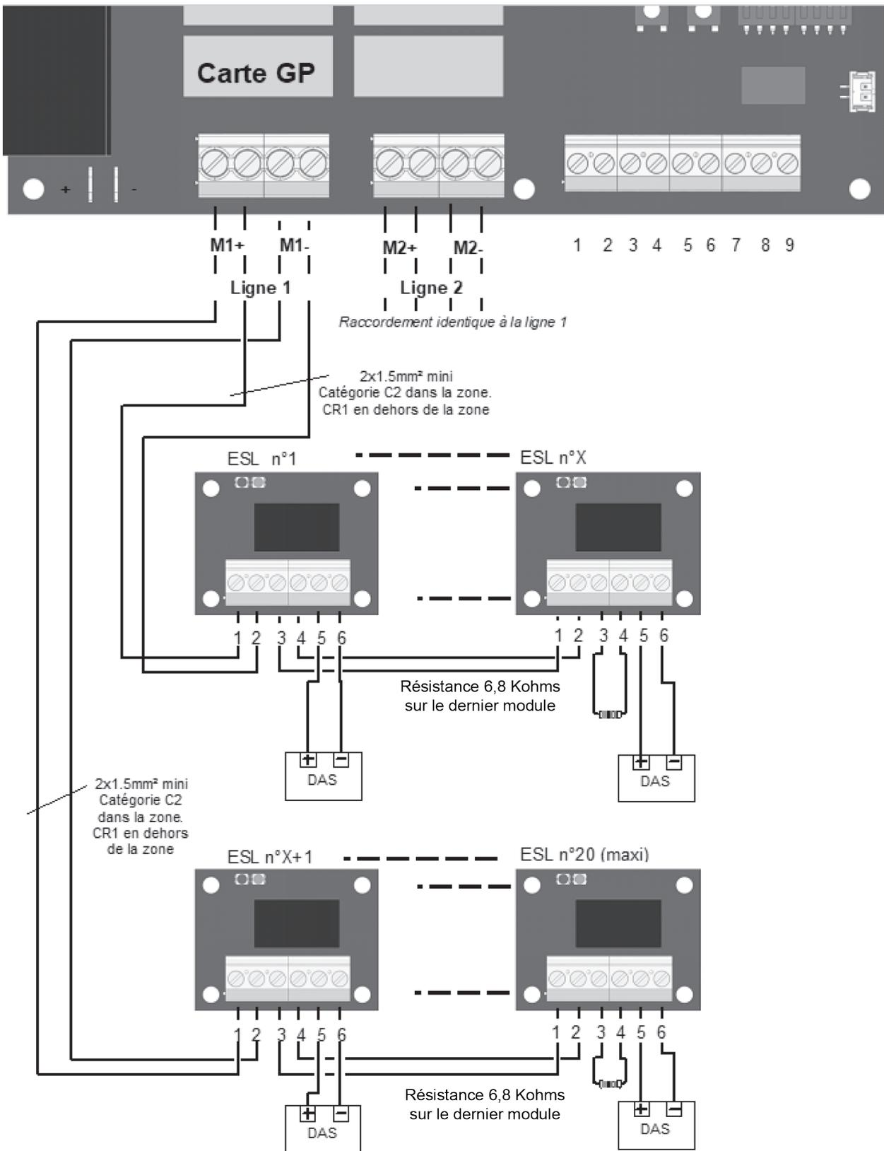
Les résistances de 6,8 Kohms doivent être raccordées en parallèle à la ligne, à moins de 3 m des 2 DAS en bout de ligne.
