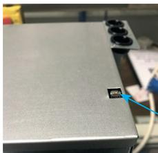
Attention présence d'un capteur d'ouverture sur le dessus à droite
