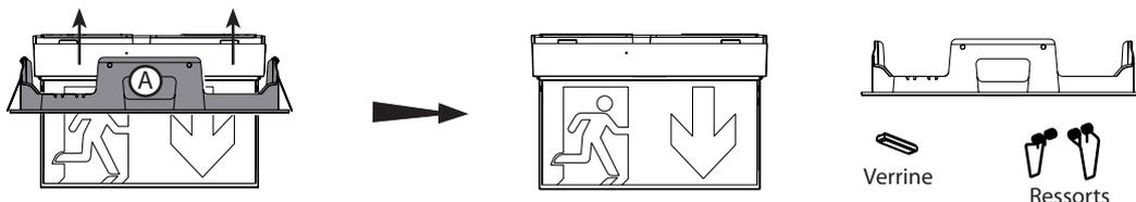
2- Séparez le mécanisme de l'embase débrochable : Appuyez simultanément sur les deux poussettes situées à chacune des extrémités du bloc
