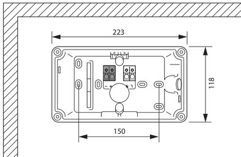
Mettre en place les bouchons (à détacher du joint) ainsi que le presse-étoupe pour assurer l'étanchéité du bloc.
