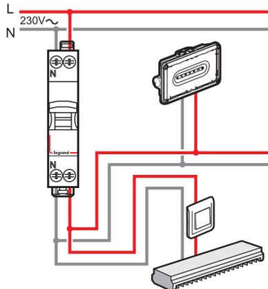
La dérivation peut se faire dans l'armoire électrique, sur l'interrupteur ou dans une boîte de dérivation. L'alimentation des blocs est soumise aux même règle que les luminaires (câblage normal).
