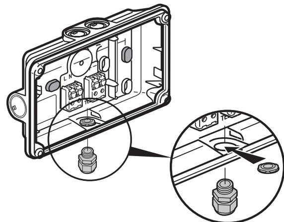
**Attention :** Le câblage du produit doit impérativement emprunter une entrée de câble basse pour respecter la règle de la goutte d'eau, et si nécessaire orienter le produit en conséquence.
