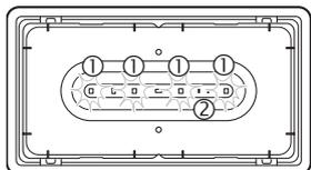
Allumage des 4 LEDs de secours blanches au flux déclaré de 400 lm ①
