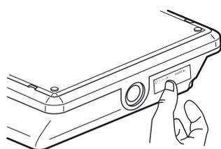
Cette étiquette de maintenance réf. 400 000) doit être apposée de manière visible sur chaque bloc autonome d'éclairage de sécurité en y inscrivant la date de mise en service du bloc.
