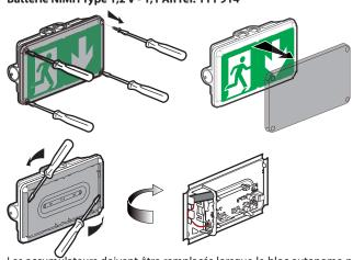
Les accumulateurs doivent être remplacés lorsque le bloc autonome ne satisfait plus à sa durée assignée de fonctionnement.
