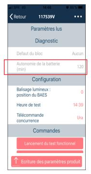
Ce paramètre permet de visualiser la durée de l'autonomie de la batterie (mesurée en minute) lors du dernier test trimestriel.
