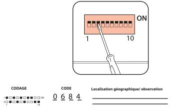
Identifier l'adresse du bloc à l'aide d'une étiquette autocollante sur le bloc (visible bloc installé)
