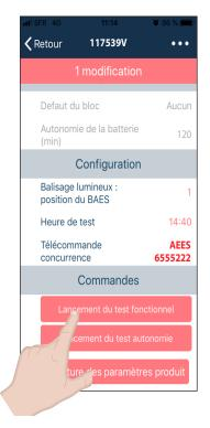
Après avoir cliqué sur test fonctionnel ou test d'autonomie, on visualise le résultat sur le bloc :
