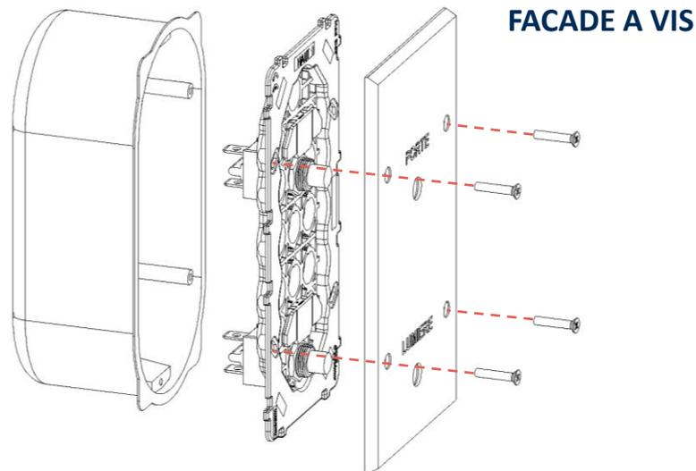
1. Réaliser le câblage du mécanisme selon le schéma correspondant.
