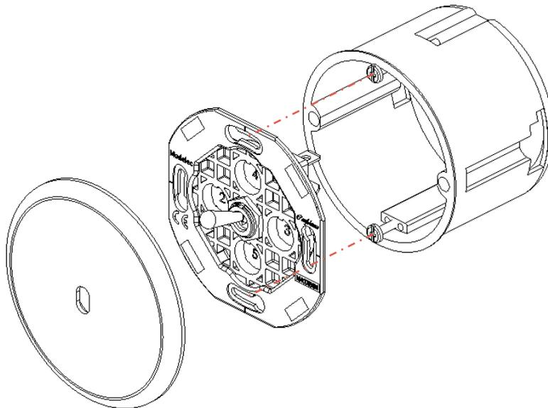
1. Réaliser le câblage du mécanisme selon le schéma correspondant.
