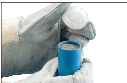
Fig. 20 – Ensuite, prendre le tube de métal d'apport inclus dans l'emballage Cadweld Exolon et retirer le couvercle par-dessus le creuset du moule.
