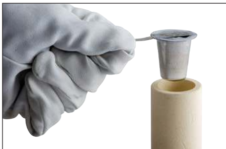
Fig. 9 – Placer la coupelle du métal d'apport dans la partie supérieure du moule. Vérifier que la bande d'allumage s'imbrique dans le renforcement sur le bord supérieur.
