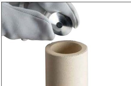
Fig. 8 – Placez le disque d'acier dans le Cadweld One Shot avec le côté concave tourné vers le haut.
