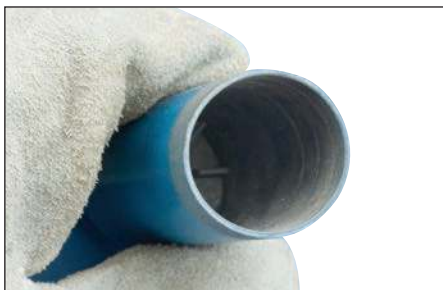
Fig. 21 – Le fond du tube contient du matériau comprimé (matériau de démarrage). Tapotez le fond du tube plusieurs fois pour détacher ce matériau.
