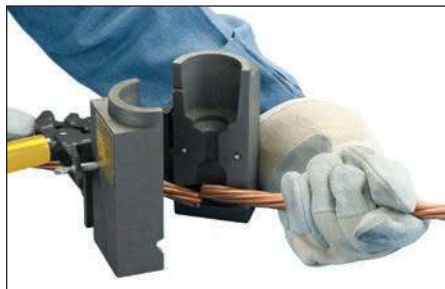
Fig. 15 – Insérez les conducteurs et positionnez-les pour la connexion.
