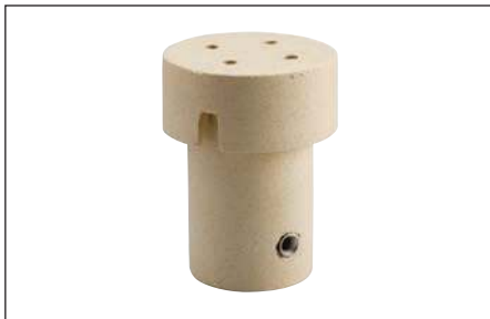
Fig. 3 – Vérifiez que le moule en céramique n'est pas usé ni cassé, ce qui pourrait provoquer une fuite de métal de soudure fondu pendant la réaction.
