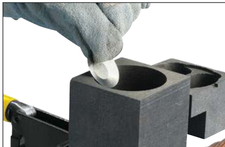
Fig. 16 – Insérez le disque en acier (côté concave vers le haut) dans le moule. Maintenez le disque en acier sur le côté du moule et laissez-le glisser en place.
