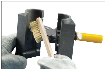
Fig. 30 – Les moules en graphite Cadweld Exolon ont une durée d'environ 50 connexions. Utiliser un chiffon en coton doux ou une brosse à poils doux (nVent ERICO, pièce n° T394 pour nettoyer l'intérieur de la cavité et du couvercle du moule ; retirer toute scorie restante de la réaction exothermique.
