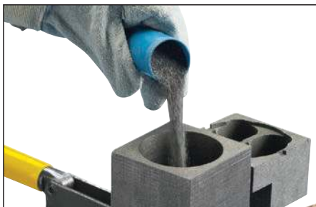
Fig. 20 – Versez rapidement la poudre de métal d'apport en vrac dans le moule.
