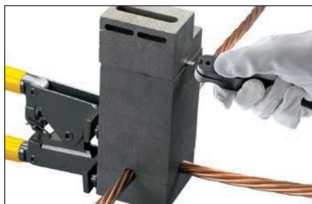
Fig. 18 – Placer la bande d'allumage dans le connecteur du boîtier de commande. Retirer ou protéger des risques d'incendie à proximité immédiate du raccordement.
