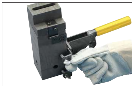
Fig. 7 – Serrer les vis à oreilles de l'attache de la poignée sur le moule.
