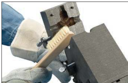
Fig. 27 – Les moules en graphite Cadweld ont une durée d'environ 50 connexions. Utiliser un chiffon en coton doux ou une brosse à poils doux (nVent ERICO, pièce n° T394 pour nettoyer l'intérieur de la cavité et du couvercle du moule.
