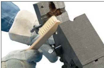
Fig. 24 – Les moules en graphite Cadweld ont une durée d'environ 50 connexions. Utiliser un chiffon en coton doux ou une brosse à poils doux (nVent ERICO, pièce n° T394 pour nettoyer l'intérieur de la cavité et du couvercle du moule.
