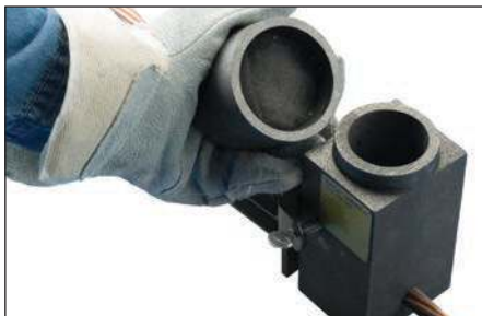
Fig. 27 – Retirer les clips d'alligator de la goupille d'allumage. Retirer le couvercle en graphite du moule Cadweld Exolon.
