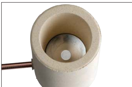
Fig. 9 – Assurez-vous que le disque d'acier est correctement installé à l'intérieur du Cadweld One Shot.
