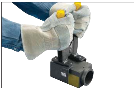
Fig. 9 – Si le moule n'est pas correctement étanche, effectuer des ajustements pour l'attache de la poignée.
