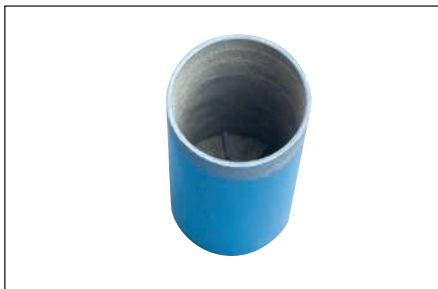
Fig. 13 – Le fond du tube contient du matériau comprimé (matériau de démarrage). Tapotez le fond du tube plusieurs fois pour détacher ce matériau.
