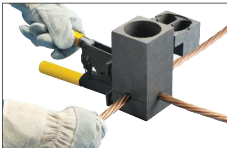
Fig. 13 – Insérez les conducteurs et positionnez-les pour la connexion.
