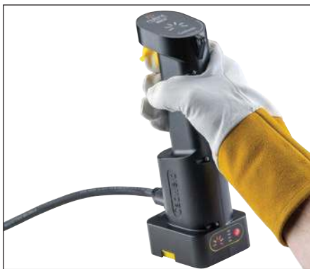
Fig. 20 – À l'aide du boîtier de commande, soulever le couvercle de la gâchette, appuyer sur le bouton d'allumage et le maintenir enfoncé. Vous verrez les 6 voyants lumineux sur le dessus de l'unité s'allumer pendant que l'unité est en charge. Lorsque le 6e voyant est allumé, l'unité envoie une charge à la bande d'allumage, déclenchant la réaction exothermique Cadweld Plus.
