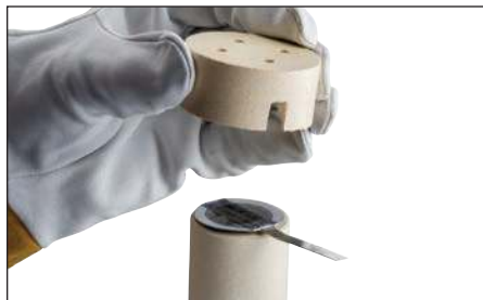
Fig. 10 – Placez le couvercle en céramique sur le moule.
