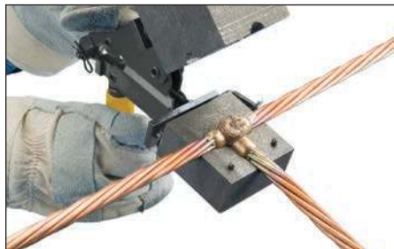
Fig. 22 – Ouvrir le moule et désactiver la connexion. Prendre des précautions pour éviter de broyer le moule. Éviter tout contact avec des matériaux chauds. Voir la section « Normes de qualité nVent ERICO Cadweld » pour voir si une connexion de qualité a été établie.
