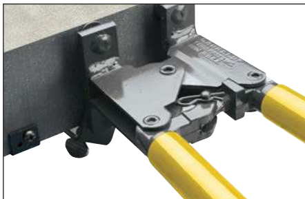
Fig. 9 – Si le moule n'est pas correctement étanche, effectuer des ajustements pour serrer/déverrouiller l'attache de la poignée.
