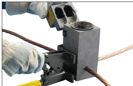
Fig. 21 – Retirer le connecteur de boîtier de commande de la bande d'allumage. Ouvrir le couvercle et retirer le gobelet Cadweld Plus usagé du moule.
