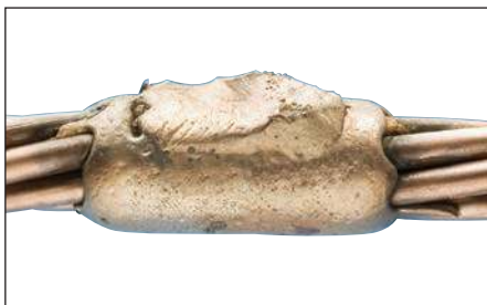
Fig. 29 – Connexion Cadweld terminée.
