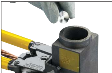
Fig. 18 – Insérez le disque en acier (côté concave vers le haut) dans le moule. Maintenez le disque en acier sur le côté du moule et laissez-le glisser en place.
