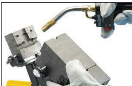
Fig. 10 – Le graphite absorbe l'humidité. Allumer le chalumeau au propane et sécher soigneusement l'intérieur du moule des deux côtés, en chauffant le moule à environ 120 degrés Celsius (250 degrés Fahrenheit).
