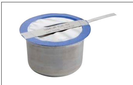
Fig. 15 – Retirer le métal d'apport Cadweld Plus approprié du récipient en plastique. Inspecter la coupelle pour s'assurer qu'elle est hermétiquement scellée et que la bande d'allumage est solidement fixée au joint.
