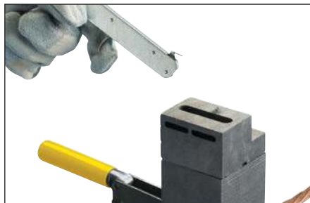
Fig. 24 – Tout en visant l'allumeur à flint sur le côté, enflammer le matériau de départ sur le couvercle du moule. Retirer rapidement l'allumeur pour éviter l'encrassement.
