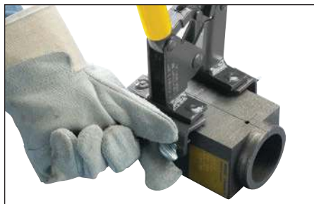
Fig. 7 – Serrer les vis à oreilles de l'attache de la poignée sur le moule.
