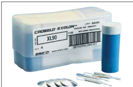
Fig. 13 – Emballage en métal d'apport (comprend le métal d'apport, les disques, les filtres et les allumeurs pour 4 connexions).
