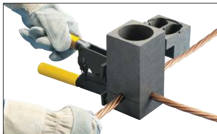
Fig. 13 – Insérez les conducteurs et positionnez-les pour la connexion.
