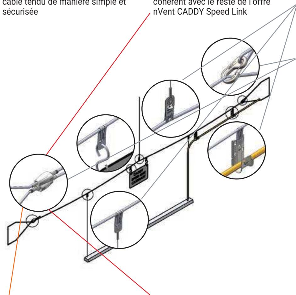
Verrou sans outils, conçu pour permettre de faire des ajustements de manière simple et sécurisée même avec des gants épais
