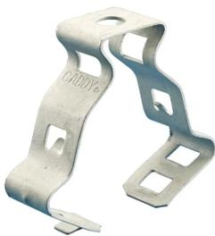
Les brides de conduits à encliqueter nVent CADDY (série M) constituent une méthode rapide et efficace pour sécuriser les circuits de dérivation des conduits pour les installations électriques. La série M est conçue pour positionner avec cohérence l'application en éliminant le décalage des conduits et en maintenant l'espacement à l'entrée des boîtes électriques. Augmentez l'efficacité de l'installation en utilisant notre gamme complète de conduits pour votre prochain projet électrique.
