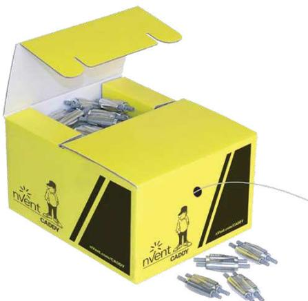
Cet emballage ingénieux permet à l'installateur de dérouler et couper rapidement la longueur de câble désirée, sans avoir à sortir la bobine de la boîte. Cet article est également parfait pour l'ajout de supports sur des installations existantes où des longueurs de câble non-conventionnelles sont nécessaires.
