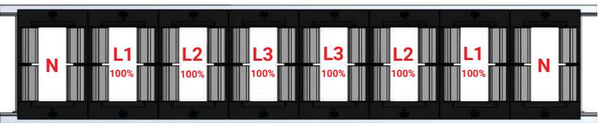
Cheminement des conducteurs optimisé (Partage de courant égal)
