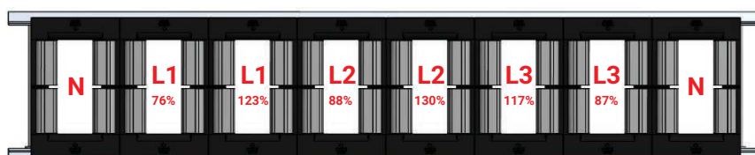
Nicht-optimierte Leiteranordnung (Laststrom unausgeglichen)
