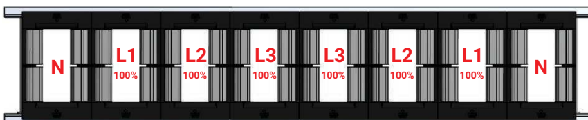
Optimierte Leiteranordnung (Laststrom ausgeglichen)
