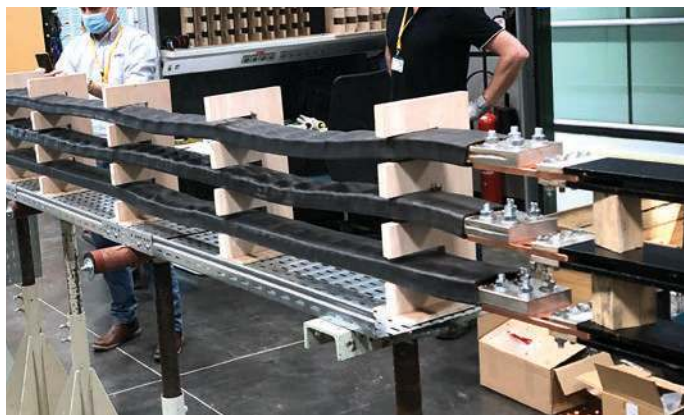
Bilder der Temperaturanstiegsprüfung und der Fühler/Temperatursensoren entlang der gesamten Anlage
