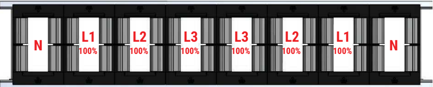
Disposición optimizada del conductor (corriente de carga equilibrada)
