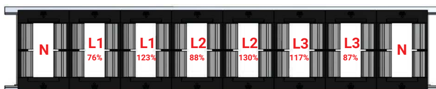
Disposizione dei conduttori non ottimizzata (corrente di carico sbilanciata)
