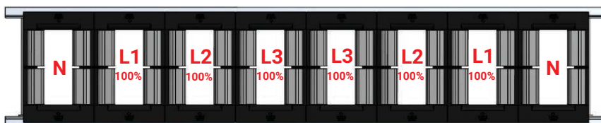
Disposizione ottimizzata del conduttore (corrente di carico bilanciata)
