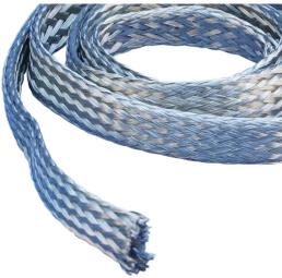
L'usage primaire de la tresse tubulaire est de fournir aux câbles sensibles un blindage EMC/EMI contre les interférences électromagnétiques, électrostatiques et radio. On obtient une performance de blindage optimale en utilisant des tresses de fils de cuivre qui peuvent également être utilisées à des fins de continuité.
