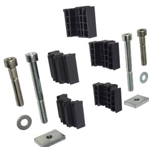
Kit de court-circuit élevé conçu pour la mise à niveau du nVent ERIFLEX IFBS afin qu'il puisse résister à des valeurs de court-circuit élevées jusqu'à 130 kA en crête. Ce kit comprend deux écrous de rail de montage, deux vis à tête M8 – CHC (75 mm), deux vis à tête M8 – CHC (40 mm) et cinq séparateurs renforcés.
