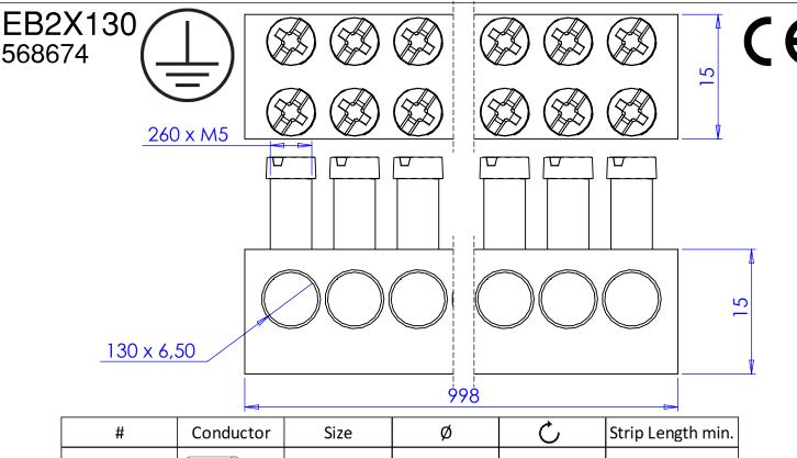
1,5 - 25mm<sup>2</sup> 6,5mm 2 Nm 8 mm 2 x 130 1,5 - 25mm<sup>2</sup> 6,5mm 2 Nm 8 mm EB130CON35 6 - 35mm<sup>2</sup> 2 Nm 8 mm EB130CON70 6 - 70mm<sup>2</sup> 2 Nm 8 mm
