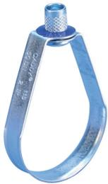
Le collier poire 115M pour charge moyenne est idéal pour la suspension de conduites stationnaires non isolées, notamment les tuyaux CPVC, dans les systèmes de gicleurs d'incendie. Un écrou d'insertion moleté permet de simplifier les réglages verticaux et ses bords évasés (tailles de 1/2" à 4") permettent d'éviter que les tuyaux n'entrent en contact avec des bords tranchants du support.
