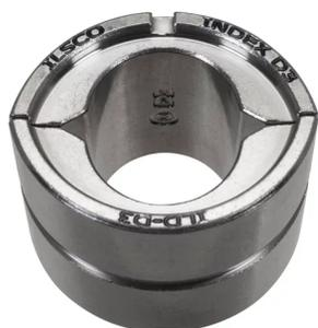
Les matrices à sertir en U par compression nVent ILSCO font partie de la gamme de connecteurs de mise à la terre par compression nVent ERICO. Les matrices en U sont compatibles avec les outils TaskMaster nVent ILSCO, y compris la pince à sertir à poignée pistolet 12 tonnes. Ils sont utilisés ensemble pour sertir les connecteurs à sertir par compression C et E dans un système de mise à la terre.
