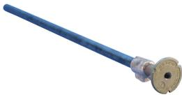
Les ponts de mise à la terre sont des ensembles faits d'un point de mise à la terre de qualité supérieure (borne de connexion) et de divers types de conducteurs. Le processus de connexion exothermique nVent ERICO Cadweld sert à les combiner pour former un ensemble durable et hautement résistant à la corrosion.
