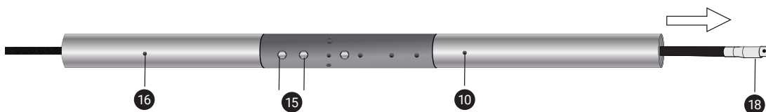
Figure 21 : Faire passer le conducteur interne dans le mât
