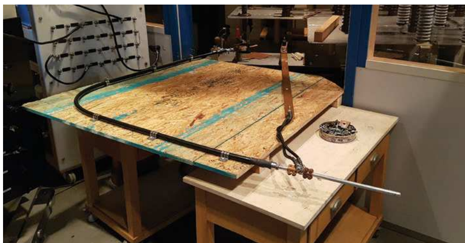
Essai en laboratoire permettant de vérifier le calibre du câble (200kA 10/350us) avec les connecteurs et les fixations.
