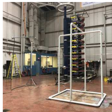
Essai en laboratoire permettant de vérifier la distance de séparation équivalente avec câble et mât autoporteur
