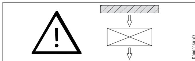
Cet appareil est conçu pour être installé devant un mur. Respectez les distances minimales. Si l'appareil est posé en champ libre ou sur un toit, le côté aspiration de l'arrivée d'air doit être protégé. Dans ce cas, réalisez un mur de protection contre le vent.
