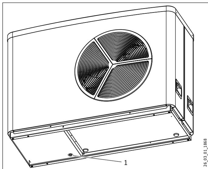
1 Écoulement des condensats
