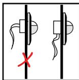
Adapté pour la pose dans une boîte encastrée de 60mm. L'entrée du câble doit être verticale.
