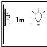
Distance minimale par rapport à l'éclairage relié à l'appareil de façon frontale ou latérale : 1 m
