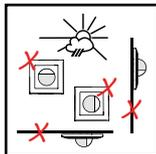
Un montage incorrect ou une utilisation non conforme à l'usage empêche le bon fonctionnement ou entraîne la destruction de l'appareil.
