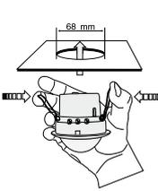
Ce détecteur a été développé spécialement pour l'installation dans des faux plafonds. D'abord, une ouverture ronde de 68 mm de diamètre doit être faite dans le plafond.
