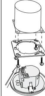
Le détecteur peut être monté au plafond dans des boîtiers simples et conventionnels.
