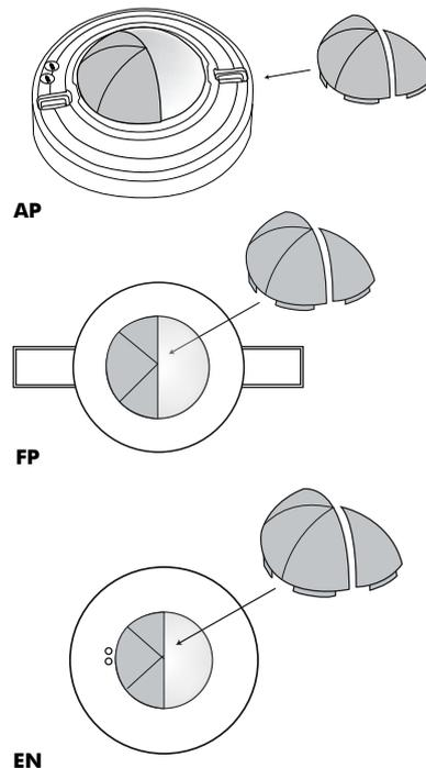
Eventuellement repousser la partie qui dépasse à la main. Replacer la lentille de Fresnel et la verrouiller en la tournant dans le sens des aiguilles d'une montre. Insérer les clips de recouvrement à l'endroit marqué.
