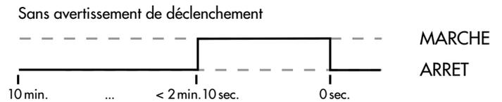
L'avertissement de déclenchement ne marche que pour les ajustements de temps au delà de 2 min. 10 sec.
