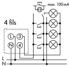
Convient également pour le raccordement du **B.E.G. LUXOMAT® Indoor 180-SC**. Extension de la zone de détection possible avec au maximum 10 détecteurs.
