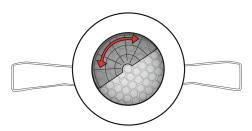
Si la zone de détection est trop grande ou il faut éliminer des perturbations (chauffage, VMC, climatisation,...), utiliser les obturateurs fournis
