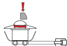
Si la zone de détection du LUXOMAT® PD9-1C-FC est trop grande ou une partie ne doit pas être vue, il est possible de réduire ou limiter la zone par des obturateurs. Placer les obturateurs comme indiqué sur le croquis ci-contre.
