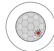
Après le raccordement électrique, le LUXOMAT® PD9-1C effectue un cycle d'auto-contrôle de 60 sec. (les LED clignotent).
