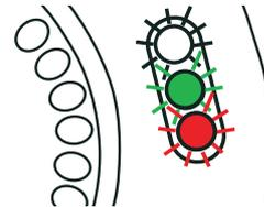
Après le raccordement électrique, le LUXOMAT® PD3N-1C-NO-PF effectue un cycle d'auto-contrôle de 60 sec. (les LED clignotent).
