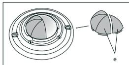
Placer les obturateurs (e) comme indiqué sur le croquis ci-dessus. Eventuellement repousser la partie qui dépasse à la main. Replacer la lentille de Fresnel et la verrouiller en la tournant dans le sens des aiguilles d'une montre.
