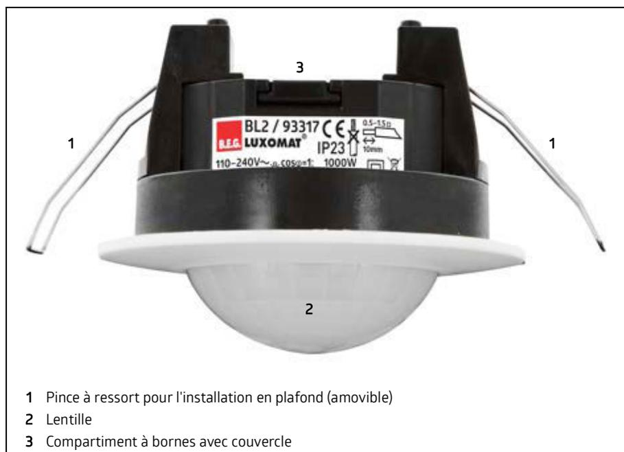
L'appareil est un détecteur de mouvement pour montage en plafond avec une zone de détection circulaire. Les réglages peuvent être effectués à l'aide de la télécommande infrarouge IR-BL.
